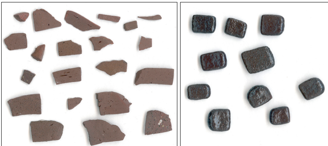
Abb. 74: Bei 1200 °C nachgebrannte Fragmente (MGR-Analyse) von Formschüsseln und Sigillata aus Nürtingen (links) und von Sigillata aus Rheinzabern (rechts). Produkte aus Rheinzabern unterscheiden sich in der Brennfärbung und im Schmelzverhalten deutlich von allen lokalen Keramikprodukten in Nürtingen.
