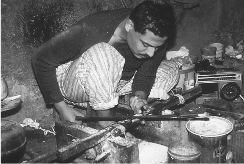
Abb. 31: Der Knochenperlendreher Mohammad Eid in Kairo beim Drechseln einer Perle. Mit der rechten Hand wird die Drehung über einen Fiedelbogen erzeugt, während die linke Hand einen Meißel gegen einen horizontal eingeklemmten Knochenzylinder hält.
