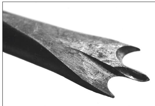
Abb. 35: Spitze eines Perlenbohrers, der an einer Seite schneidet. Es handelt sich um keine historische Rekonstruktion, sondern um einen Entwurf (von H. JÄGER, Michelstadt/Odenwald) nach modernem technischen Wissen zur praktischen Nutzung in der Rekonstruktion des Nürnberger Bohrers.
