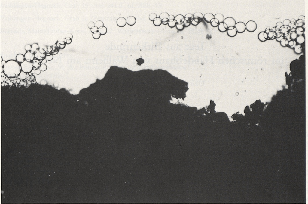
Abb. 1 Fettes Öl, ausgetreten aus der grob-granulären schwarzen Substanz im mikroskopischen Bild. Behandlung mit Xylol und Glycerin. Die schwarz umrandeten Kreise sind kleine Ölkugeln an der Flüssigkeitsgrenze Xylol (unten) und Glycerin (oben). Zwischen den Ölkugeln und der schwarzen Substanz sieht man schwach in weiß-grauer Färbung (natürliche Farbe gelb-grün) das noch nicht zu Kugeln abgerundete Öl. Vergr. 190 × (Aufnahme KÖRBER-GROHNE).
