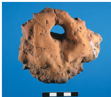
Abb. 14: St. Johann-Würtingen ‚Fohlenhofer Feld‘: Düsenfragment zur Windzufuhr in den Brennraum eines Rennofens mittels Blasebalg.
