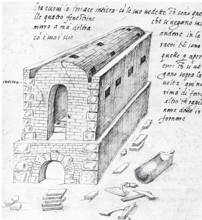
Abb. 10: Ofen des Typs Piccolpasso aus dem Keramiktraktat des gleichnamigen Autors.
