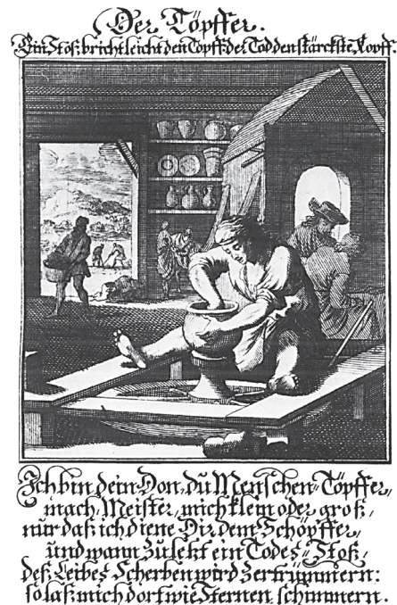
Abb. 2: Darstellung eines Töpfers aus dem Ständebuch des CHRISTOPH WEIGEL, 1698. Im Hintergrund ein stehender Töpferofen mit rechteckigem Grundriss.
