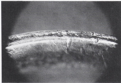
Abb. 30 Nehren. Kante des Goldrings mit Quetschfalte (Überlappung). Vergr. 5:1.
