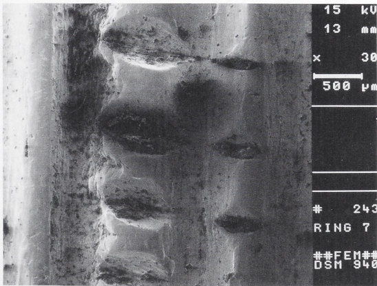
Abb. 8 Nehren. REM-Aufnahme des gekerbten Mittelstegs.
