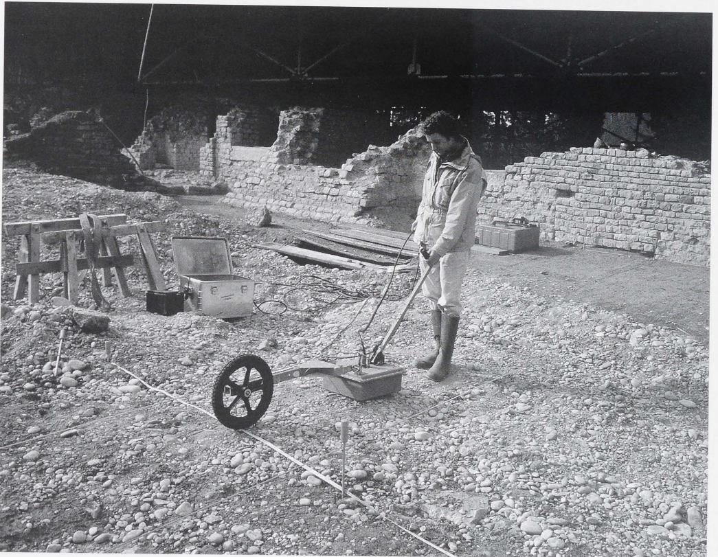
Abb. 33 Badenweiler, Römische Heilthermen. Einsatz der 500-MHz-Antenne am Südrand der Bäderruine.
