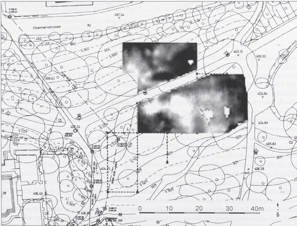
Abb. 19 Badenweiler. Ergebnis der geoelektrischen Untersuchungen im östlich der Bäderruine gelegenen Bereich.
