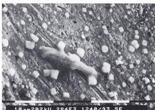
Abb. 14b Würfelförmige (kubische) Silberchlorid-Kristalle ( $\text{AgCl}$ ) als typische Korrosionsprodukte auf der Oberfläche des immobilisierten PHILIPPOU-Staters E1292 [4] von Tarodunum sind bei 2800facher Vergrößerung sichtbar (Fotos: REM-Labor, Universität Basel).
