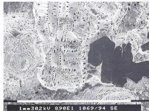
Abb. 11b Goldprodukt F9723 [8] zeigt flächendeckende Löcher, die meist symmetrisch angeordnet sind. Wie Abb. 11a im Bildteil rechts (dunkle Fläche) mit hexagonalem Kupferglimmer-Kristallaggregat (Foto: 89fache Vergrößerung, REM-Labor, Universität Basel).
