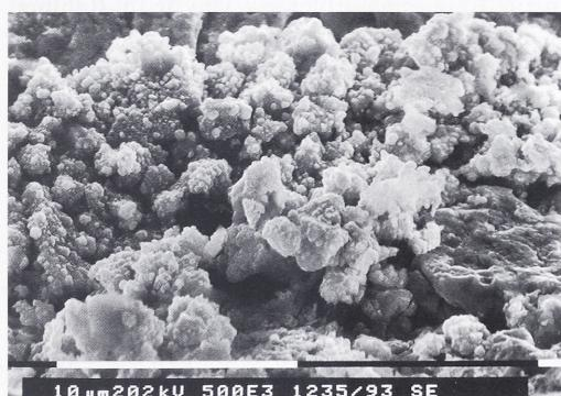
Abb. 14a Die Korrosionsschicht eines massiven KALETEDOU-Quinars vom Kegelriß [46] zeigt bei 5000facher Vergrößerung starke Agglomerationen der Korrosionsprodukte, die mineralogisch durch XRD als Chlorargyrit/Kerargyrit (dt. Hornsilber) exakt definiert werden können.
