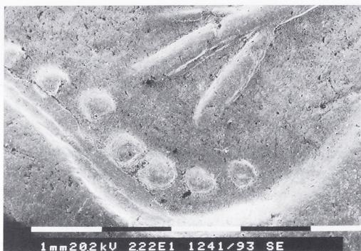
Abb. 16 Teilsicht der Rückseite des PHILIPPOU-Typs [4] in 20facher Vergrößerung. Die winzigen Poren sind flächendeckend erkennbar (Foto: REM-Labor, Universität Basel).
