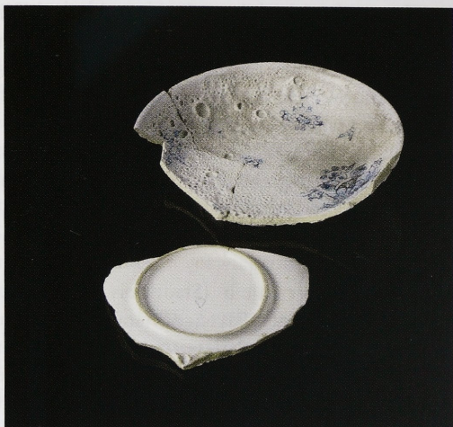
Abb. 80,2 Karlsruhe D u r l a c h. Während des Glasurebrandes missratene Untertassen mit blauem Maldekor; auf dem vorderen Bodenstück ist eine Malermarke zu erkennen.
