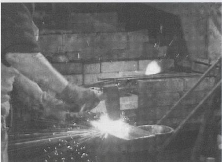
Abb. 36 Feuerverschweißung: Die Viskosität der Schlacke nimmt wie bei Glas mit steigender Temperatur ab, so dass ein Austreiben der Schlacke aus dem Fügespalt umso leichter gelingt, je höher die Schweißtemperatur gewählt wird. Schmied: K. Stoll, Aufnahme: M. Paysan.
