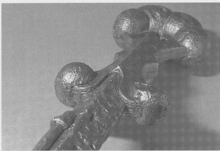
Abb. 35 Griffbereich des Schwertes aus Eislingen/Fils, Kat.-Nr. 5. An der Oberfläche dieses Schwertes ist deutlich die Schichtstruktur des gegärten Stahles zu erkennen, so dass sich anhand der Verformungen viele Arbeitsgänge rekonstruieren lassen. Breite am Heft: 5,7 cm. Ohne Maßstab. Aufnahme: M. Paysan.
