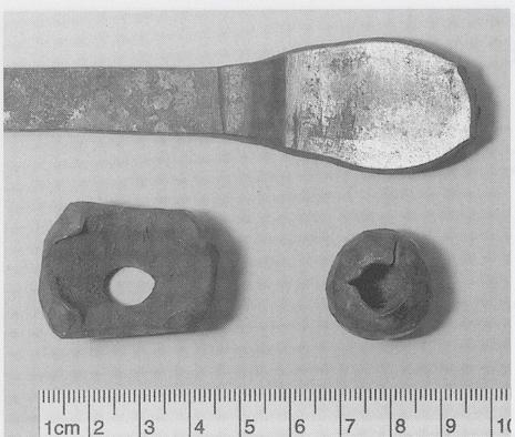
Abb. 57 Schmiedeversuche zur Schüsseltechnik. Oben: Flachgeschmiedetes Stabende; unten links: Beim Aufziehen einer bereits durchlochten Platte weitet sich das Loch, daher ist die Durchbrechung erst nach Fertigstellung der Kugelform durchzuführen; unten rechts: Aus flachgeschmiedetem Stabende aufgezogene Kugel in Schüsseltechnik. Aufnahme: M. Paysan.
