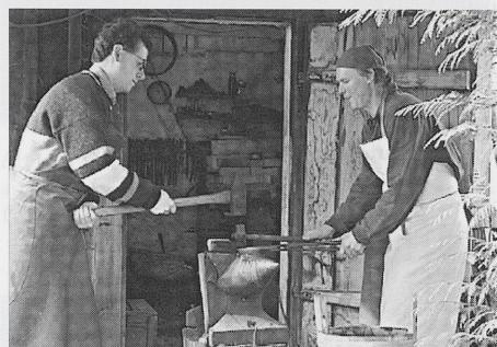
Abb. 47 Mit einem breiten Kehlhammer lassen sich ungewünschte Verwölbungen begradigen und Fehler im Verlauf des Mittelgrates korrigieren. Schmiede: links: M. Paysan, rechts: K. Stoll. Aufnahme: M. Paysan.
