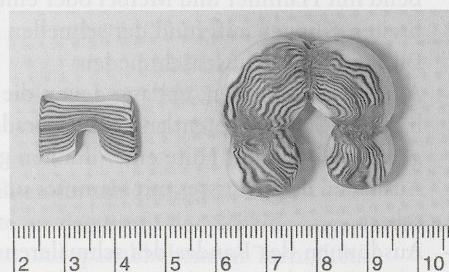
Abb. 61 Knetmodell eines umformend gefertigten Knaufes. Links: Querschnitt durch den rechteckigen Ausgangsstab mit eingemeißelter Kehlung, die später die Knaufzunge aufnimmt; rechts: fertiges Modell. Aufnahme: M. Paysan.
