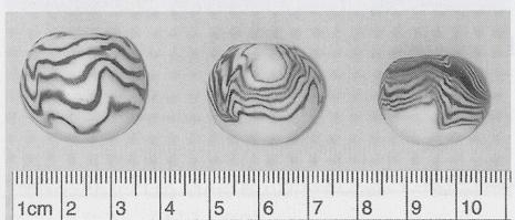
Abb. 58 Knetmodelle zur Vielfalt der möglichen Verwerfungsbilder an der Oberfläche von Knollen, die nach der Schüsseltechnik hergestellt sind. Aufnahme: M. Paysan.
