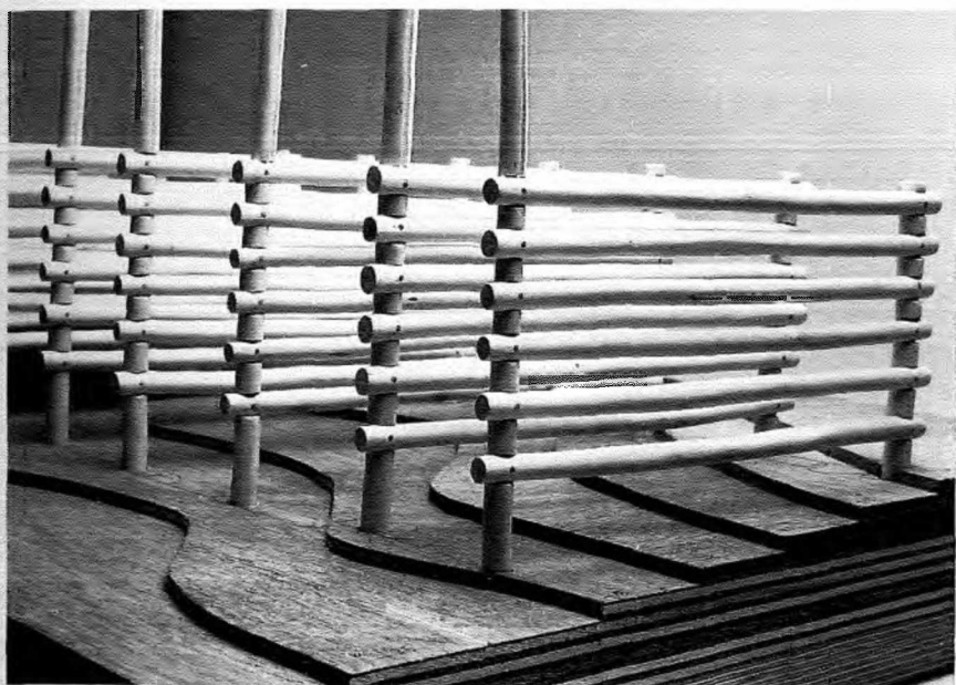
Abb. 4 Zwischenzustand des Modells zur Ringmauer bei Preist mit der Folge der hölzernen Querelemente.
