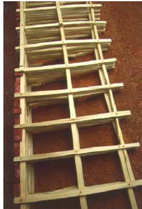
Abb. 6 Murus Gallicus -Modell Kastel, Holzkastenwerk mit Frontverblendung ohne Erdschüttung.
