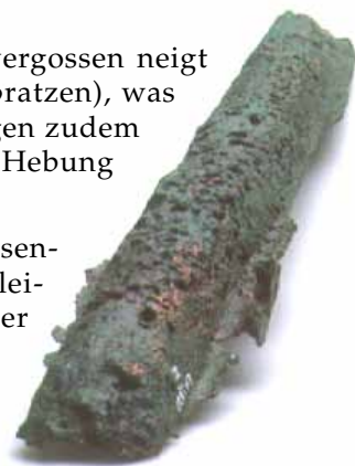
Abb. 4 Barren mit starker Blasenbildung und über den Rand der Form geflossenem Kupfer.
