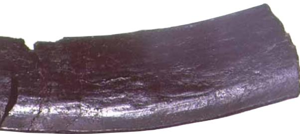
Abb. 4 Treibspuren im Eisenrand.
