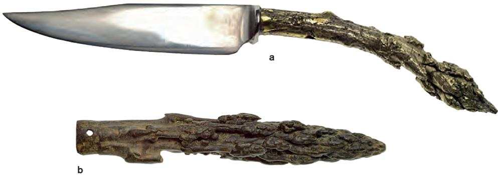
In Kaltarbeit kann man, wenn nötig, die Gussstücke überarbeiten. Bei unserem Guss war das nicht erforderlich. Dann wird der einzelne Metallspargel vom Bronzeblock des Angusses abgesägt. Um eine Messerklinge zu montieren, muss der Spargel mit einer Längsbohrung versehen werden. Das fertige Ergebnis sieht aus wie die römischen Vorbilder. Das Experiment ist also geglückt, die These bewiesen [Abb. 12].
