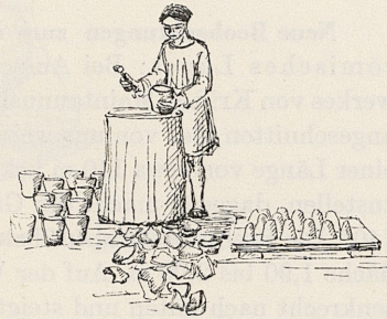
Abb. 4. Bad Nauheim. Zerschlagen der Kleinbehälter zur Gewinnung von Formsalz.
