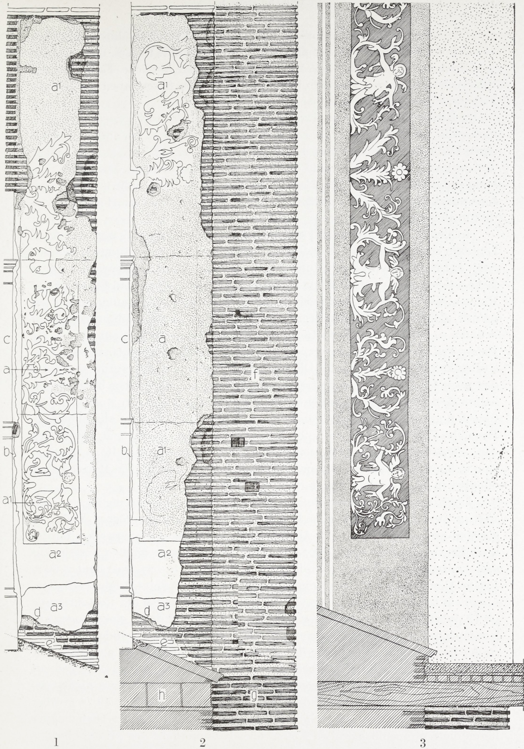
Abb. 5. Trier, Aula Palatina. Zeichnerische Aufnahme (1. 2) und Rekonstruktion der Fensternischendekoration (3), nähere Erklärung s. S. 199. M. 1:40.
