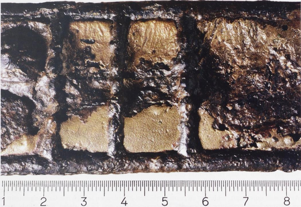
Abb. 11. Stark verschmolzene Partie der Buntmetallscheidenteile 2a und 2b auf dem Klingenblatt.
