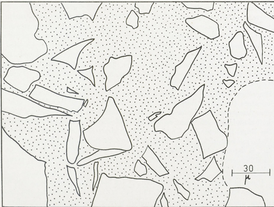
Abb. 3. Allendorf (Hessen). 1 Bildausschnitt aus der Perle Abb. 2. Quarz: weiß mit ausgezogenen Linien; Poren: weiß mit gestrichelten Linien; Kittmasse einschließlich mikro- bis kryptokristallinem Quarz: punktiert. Die Verbindung der am Rand eingerissenen Linien ergibt den Bildausschnitt zu 2. 2 Bildausschnitt zu 1. Signaturen wie dort. Der Quarzanteil ist splitterig, scharfkantig und spitz.
