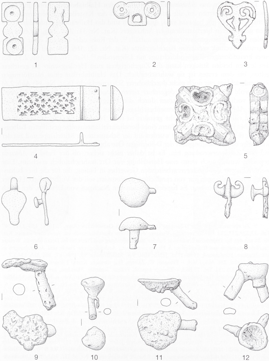
Abb. 2. Eining. 1–8 Halbfabrikate, Roh- und Fehlgüsse; 9–12 Gußköpfe. Bronze. – M. 2:3.
