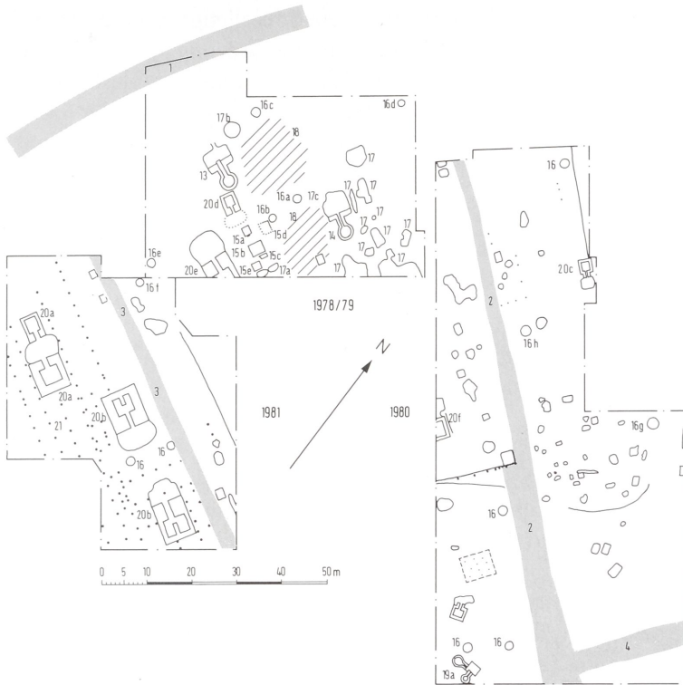
Abb. 7. Rheinzabern. 24 Morgen. Grabung 1978–81. Befunde der Manufakturzeit. – 1–4 Straßen u. Wege; 13 Sigillata-Brennofen 1; 14 Sigillata-Brennofen 2; 15 a–e Schlämmanlage; 16 Brunnen; 17 Abfallgruben; 18 Abfallhalde; 19 kleine Töpferöfen; 20 Ziegelbrennöfen; 21 Werkhallen. – M. 1: 1500.
