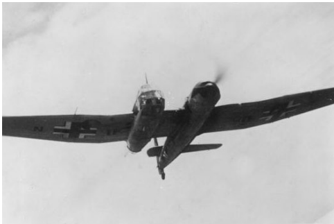
Fig. 4: The asymmetric bomber Blohm & Voss BV 141 in 1942. Bundesarchiv, Blohm & Voss BV 14. (2020), https://de.wikipedia.org/wiki/Blohm_%26_Voss_BV_141#/media/Datei:Bundesarchiv_Bild_183-B21073_Aufkl%C3%A4rungsflugzeug_Blohm_-_Vo%C3%9F_BV_141.jpg , access: March 20, 2021, 03:00pm.
