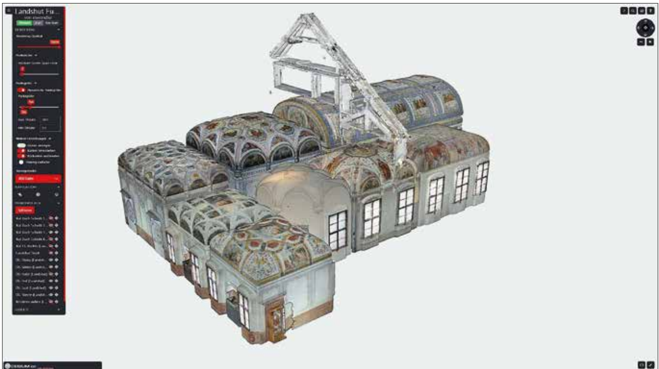
Abb. 3 Stadtresidenz Landshut. Homogene 3D-Punktwolke zur Unterstützung der CAD Auswertung und als Grundlage zur Berechnung von Orthophotos (Foto Bernhard Strackenbrock)
