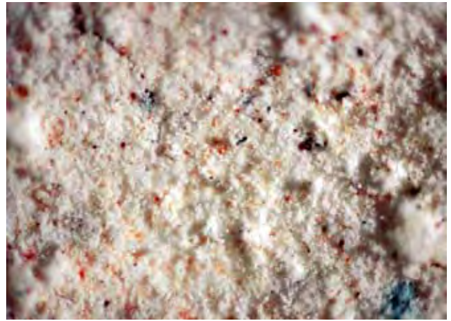
Abb. 19: Freising, Dom St. Maria und St. Korbinian, Pigmentverteilung des Hämatits in der Kalkmatrix (Vergr. 50x)
