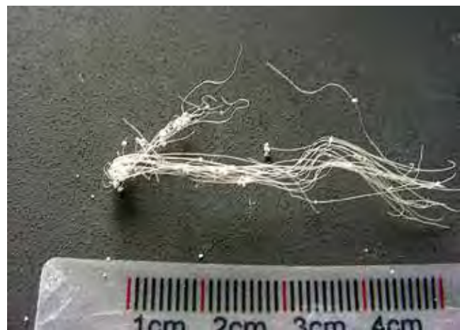
Abb. 10: Flachfasern aus der Putzprobe
