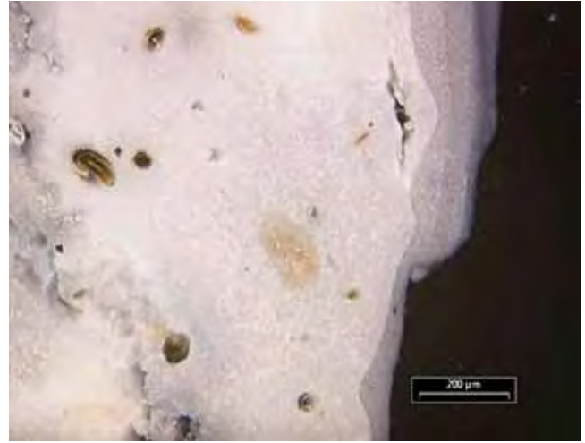
Abb. 14: Querschliff der Probe (200-fache Vergrößerung). Auf der Stuckoberfläche (rechter Bildbereich) liegen noch stellenweise mehrere Fassungen auf.
