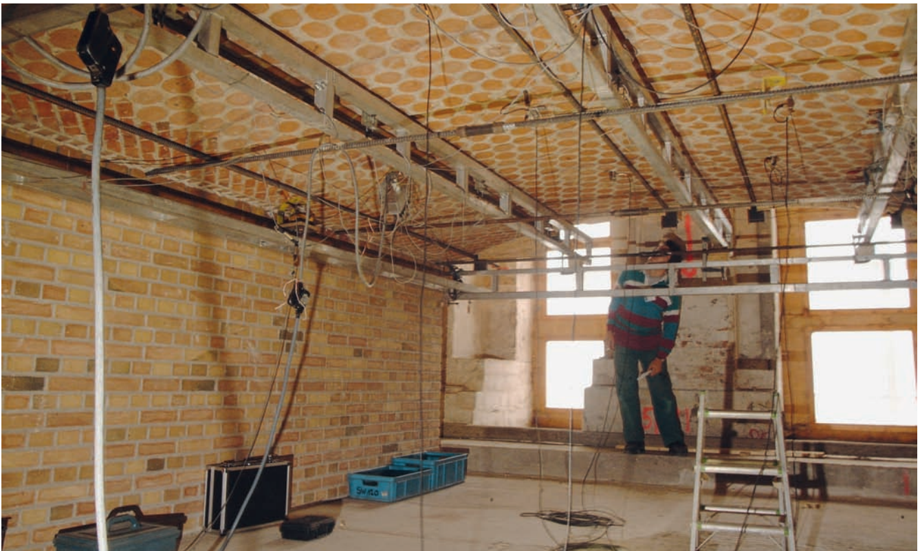
Abb. 4. Belastungsuntersuchungen an einem Probegewölbe aus Tontöpfen, das in historischer Werktechnik die im Bestand vorhandenen Gewölbe nachbildet. Fig. 4. Load tests on a sample vault made of clay pots, which replicates the historic production technology used to build the surviving vaults.
