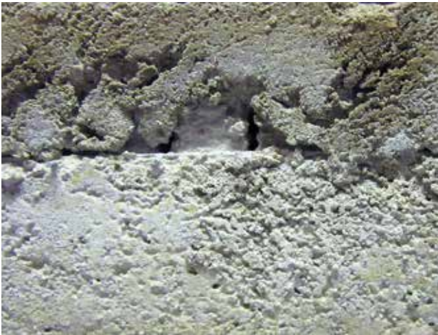
Abb. 16: Querschnitt einer Musterplatte Serie 2 mit zu schwachem Haftverbund
