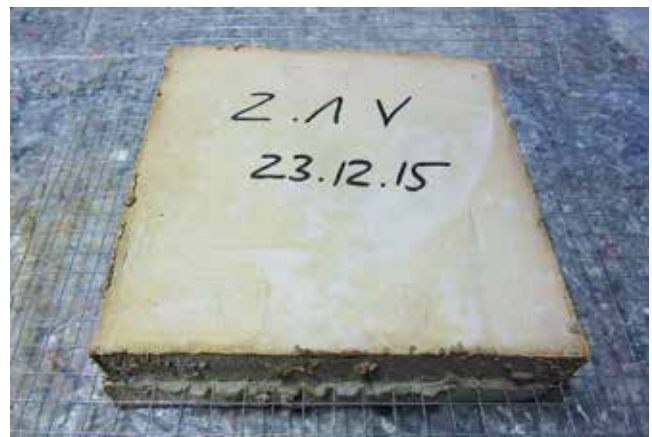
Abb. 15: Musterplatte Serie 2 mit Punktschweißgitter
