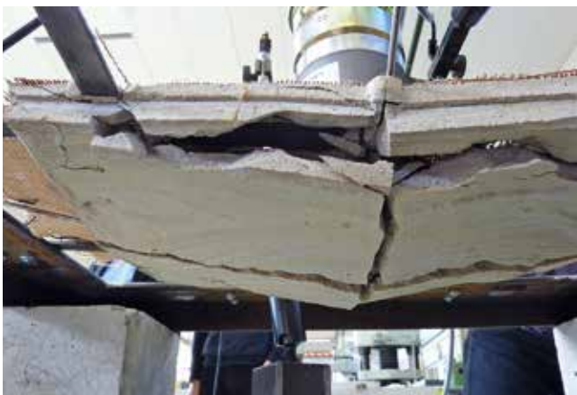
Abb. 14: Druckfestigkeitsprüfung an Musterplatte Serie 1
