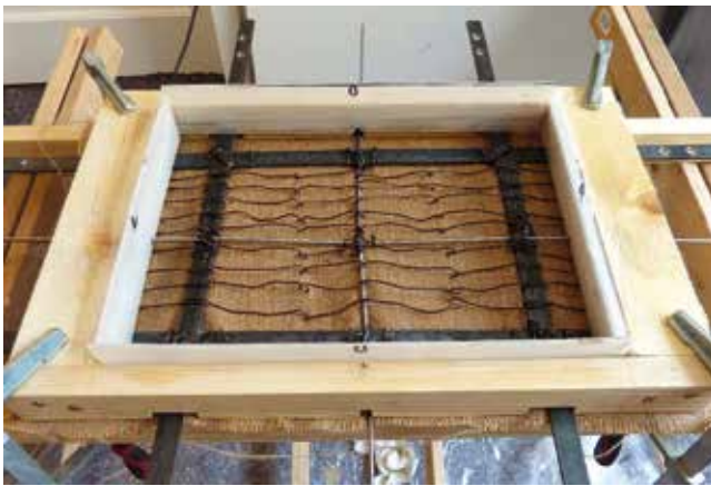
Abb. 12: Nachbau historische Armierung
