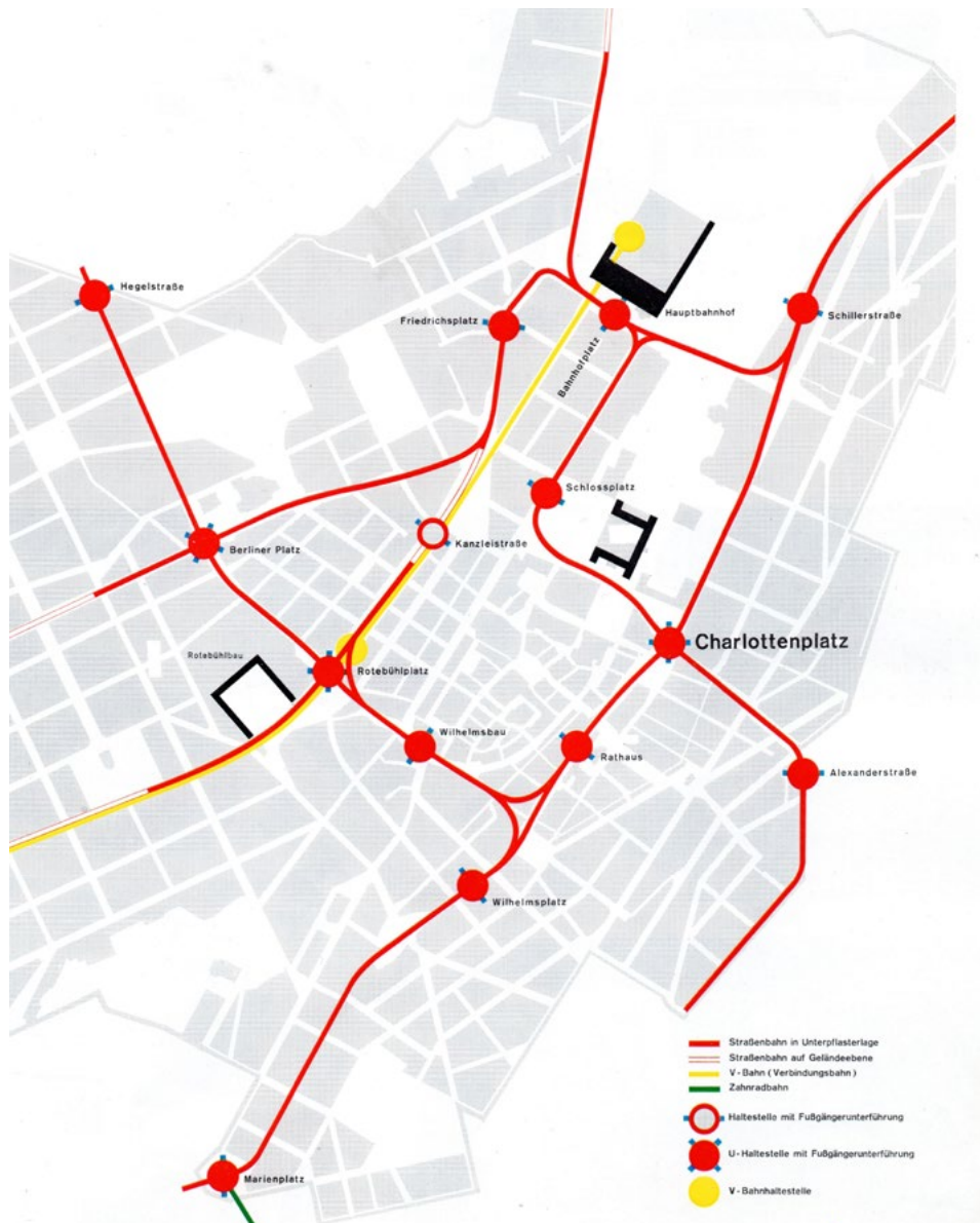
Abb. 2: Streckennetz der U-Strab im Stuttgarter Zentrum, Planung von 1966: Der Charlottenplatz hat die Funktion eines sogenannten Knotenpunkts mit Umsteigefunktion. Der City-Ring – eigentlich ein Längsrechteck – zwischen Hauptbahnhof und Rotebühlplatz, ist erkennbar
