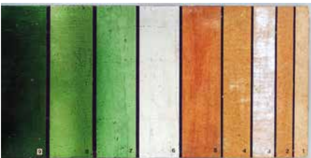
Abb. 3d Musterplatte mit Darstellung der Schichtenabfolge für die Rekonstruktion des grünen Lüsters im Grünlackierten Zimmer, gefertigt in den frühen 1970er Jahren (Foto Schloss- und Gartenverwaltung Würzburg, S. Vogt, 2022).
