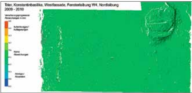
Abb. 7-12: Sohlbank Fensterachse W4, Flechtenbesiedlung an der Konstantinbasilika
