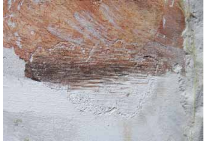
Abb. 14-14: Unveränderte Oberfläche nach Abnahme des Klebepunktes
