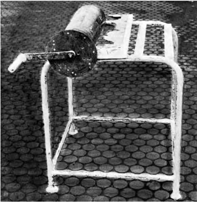
Abb. 7: Arbeitstisch zum Drehen von Säulen oder Balustern
