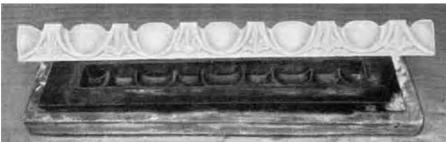
Abb. 14: Flexible Form mit Stützmantel
