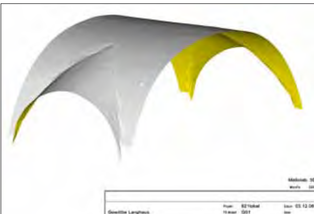
Abb. 11: Idealisierung eines Tonnengewölbes mit seitlich aussteifenden Kappen
