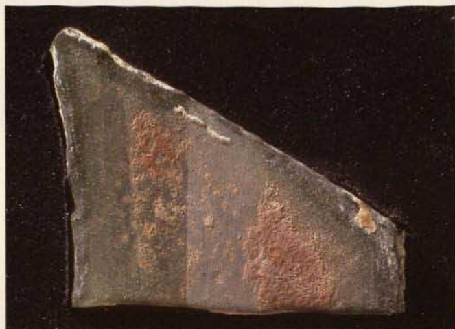
Abb. 3. Köln, Dom, Fenster nVI, Feld 12dr, Reinigungsproben: von rechts unbehandelt, weicher Pinsel, Wish-ab-Schwamm, härterer Pinsel und Skalpell (1994).
