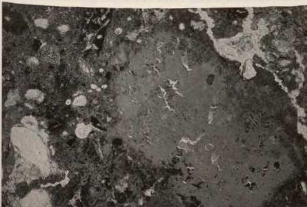
Abb. 4: Fugenmörtel von der Südwand des Cryptoporticus des „Großen Tempels“ in Petra mit Kalkspatzen und Holzkohlepartikeln. Der Dünnschliff (gekreuzte Polarisatoren) links zeigt einen Kalkspatz als zuschlagsfreie Zone, bestehend aus mikrokristallinem Calcit. Zahlreiche Risse sind durch sekundäre Gipskristallisation verfüllt
