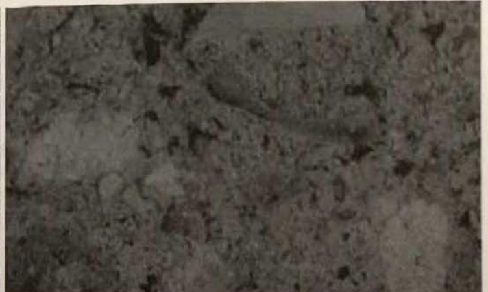
Abb. 4: Fugenmörtel von der Südwand des Cryptoporticus des „Großen Tempels“ in Petra mit Kalkspatzen und Holzkohlepartikeln. Der Dünnschliff (gekreuzte Polarisatoren) links zeigt einen Kalkspatz als zuschlagsfreie Zone, bestehend aus mikrokristallinem Calcit. Zahlreiche Risse sind durch sekundäre Gipskristallisation verfüllt
