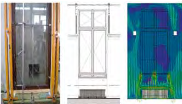
Niobidensaal, links: Prototyp des modifizierten Bestandsfensters im Prüfstand des Instituts für Fenstertechnik in Rosenheim, rechts: CFD Simulationsmodell des Fensters von Müller-BBM. Зал Ниобидов, слева: образец модифицированного оригинального окна на испытательном стенде института оконной техники в Розенхайме, справа: имитационная, по расчётной гидродинамике (CFD), модель окна фирмы Müller-BBM.
