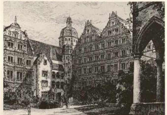
Abb. 6. Heidelberger Schloß. Entwurfszeichnung Karl Schäfers (1900) für die Wiederherstellung des Ottheinrichbaus mit zwei großen Giebeln nach der Zeichnung von Matthäus Merian 1620.
