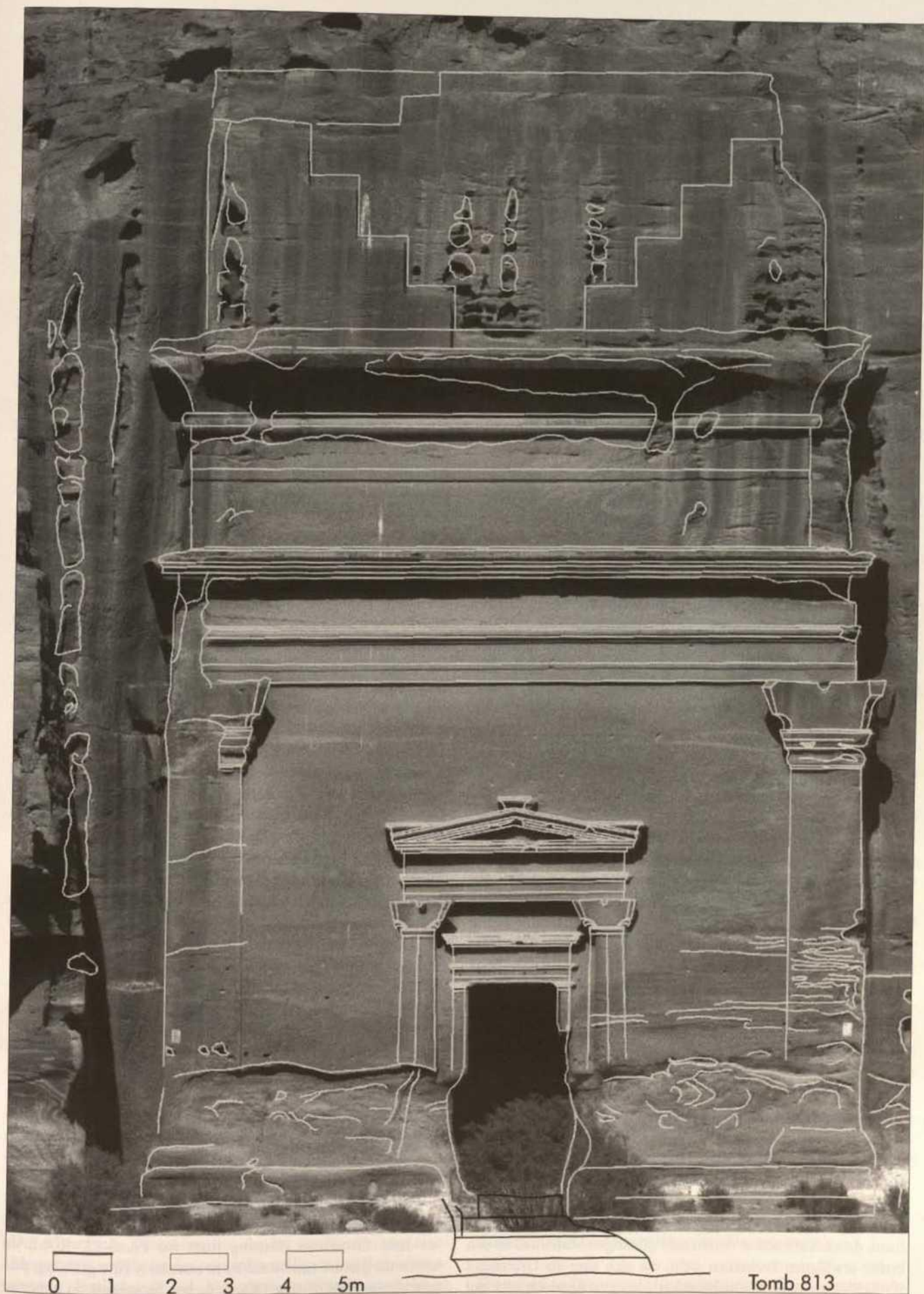
Abb. 2. Grabmonument 813, Überlagerung von Bildplan und Photogrammetrie / Fig. 2. Tomb 813, photogrammetrical elevation superimposed to the picture plan
