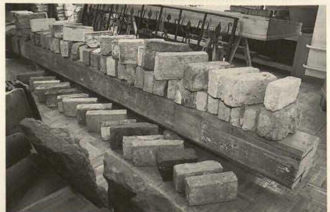
Abb. 2. Auswahl verschiedener Mauerziegelformate.
