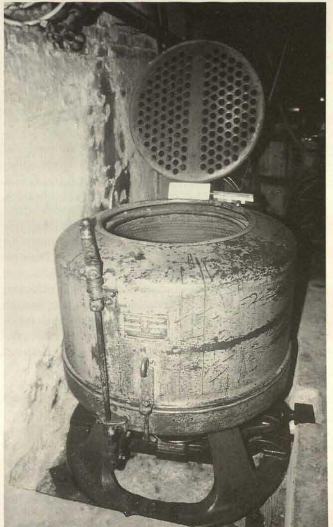
Abb. 8. Die Wollschleuder nach der Restaurierung für den „Zustand 1961“. Alle Gebrauchsspuren am Gehäuse wurden erhalten.
