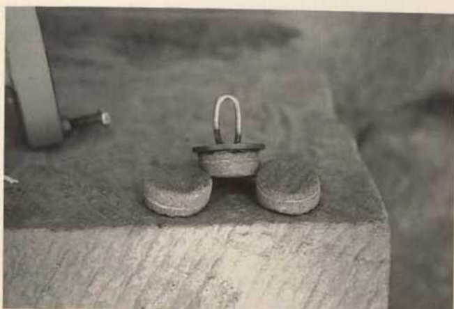
Abb. 6. Haftzugmessung. Stempel nach Bruch in der Ersatzmasse
