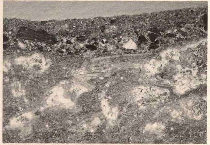
Abb. 4. Querschliff der in den Lack eingebetteten Textilfasern und der beiden darüber liegenden Grundierungsschichten, 100-fache Vergrößerung, am Dosenrand unter Silberfassung entnommen, keine Abschlusslackierung
