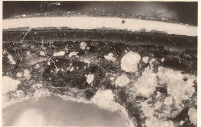
Abb. 5. Querschliff, im Doseninneren im Bereich des in Schwarzlack gemalten Dekors entnommen, 200-fache Vergrößerung
