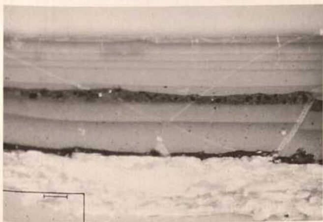
Abb. 7. Querschliff 8, 200-fache Vergrößerung, UV-Licht, Probe wurde aus der runden Tabakdose entnommen mit der Darstellung: „Monsieur de la flute“, Städtisches Museum Braunschweig
