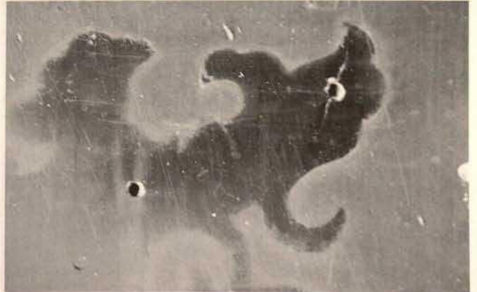
Abb. 6. Bad Homburg, japanisches Lackkabinett, original erhaltene Lackoberfläche im Vergleich zum UV-geschädigten Bereich
