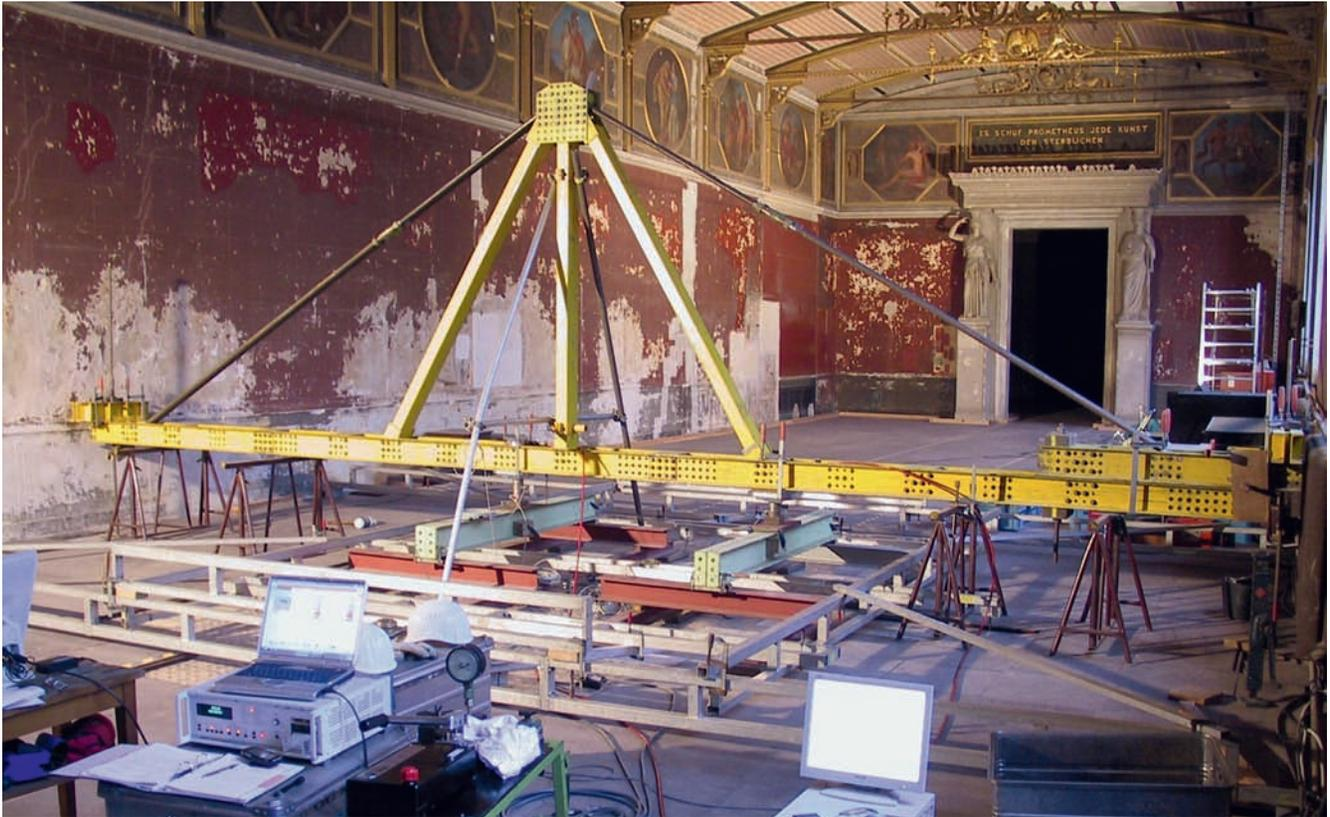
Abb. 3. Berlin, Neues Museum, Niobidensaal: Belastungsuntersuchungen vor und nach der Verstärkung der Eisengussträger mit CFK-Lamellen.
