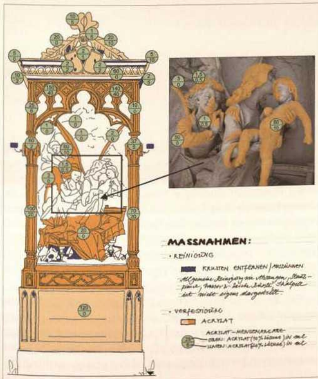
Abb. 8 Grab La Roche, Maßnahmenkartierung, Darstellung der in situ gefestigten Bereiche mit Mengenangabe des eingebrachten Mittels
