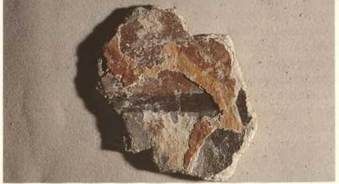
Abb. 249. Reichenau-Mittelzell, Münster, Mörtelfragment (1/25/C) aus der Grabung Reisser mit mehrschichtigem Fassungsauflauf verschiedener Phasen: auf dem Mörtel freskale (?) Malschicht und drei Tünchen mit Fassung (1995).
