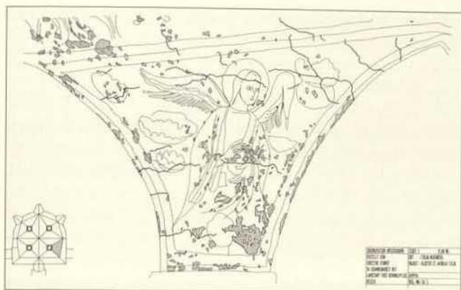
Abb. 314a-b. Fulda-Neuenberg, St. Andreas, Krypta, Bestands- und Zustandskartierung an zwei ausgewählten Bereichen der Süd- (a) und der Nordwand (b): Risse und pudernde Malschichten (C. Kenner).
