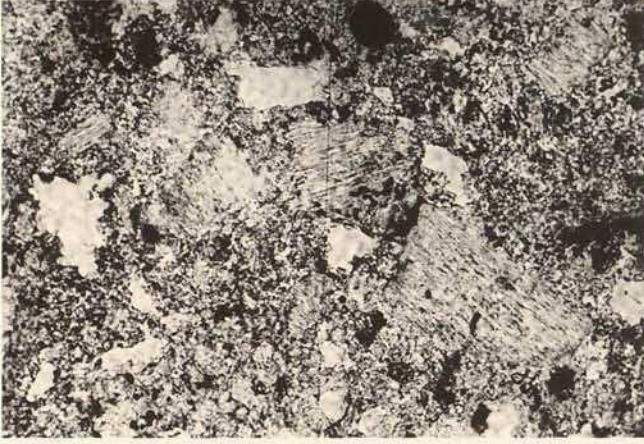
Abb. 26. Mikrofotographie einer Stuckprobe aus dem sog. Tempietto von Cividale: Ausschnitt mit geringem Anteil von Zuschlagstoffen (feinem Sand, Ziegelsplitt, gemahlenem Marmor) sowie der optisch nicht auflösbaren Gipsmatrix (d = 3mm).
