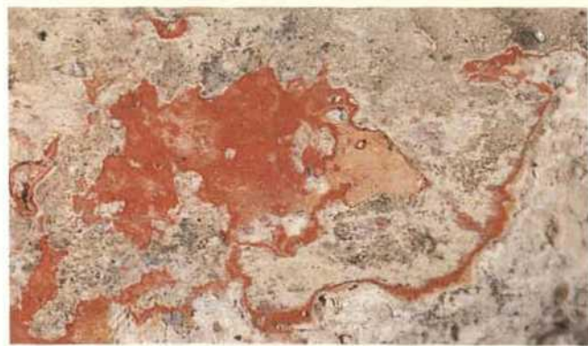
Abb. 147. Stuttgart, Landesdenkmalamt, Stuckfragment aus der ehem. Klosterkirche Großkornburg (Mag.-Nr. 034), Detail mit mehrschichtigem Fassungsaufbau: kräftiges Rot als Lasurschicht auf Mennige.
