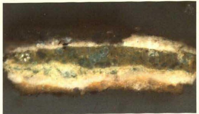
Abb. 154. Stuttgart, Landesdenkmalamt, Stuckfragment aus der ehem. Klosterkirche Großkornburg (Mag.-Nr. 407-408/0010), Querschliff der Probe 3 (s. Anhang).
